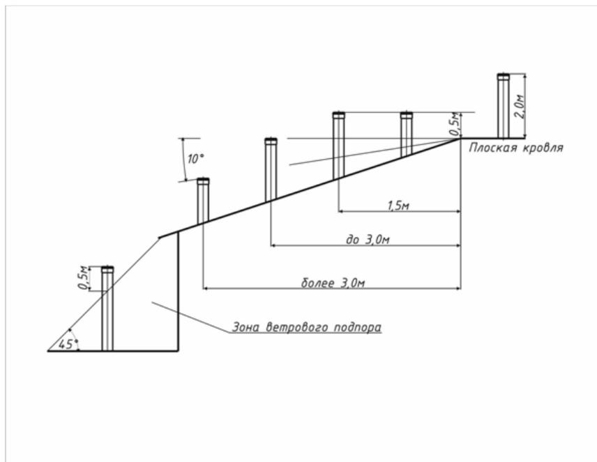
Высоту дымовой трубы над крышей (в зависимости от расстояния ее до конька крыши) рекомендуется выполнить как показано на рис. 3.
