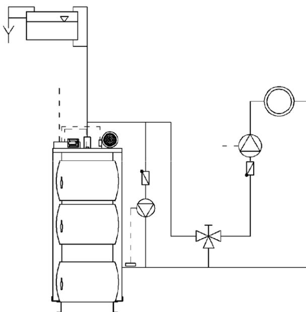
Подключение с 3-х ходовым клапаном и водонагревателем
