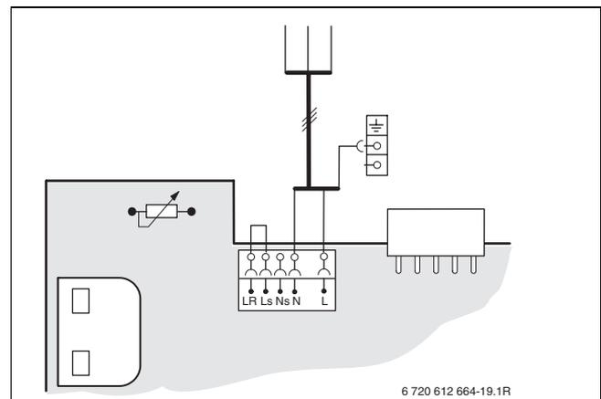
Рис 34 Клеммная колодка для подачи питания ST10
