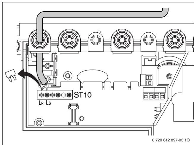
Рис 22 Подключение (230 В AC, снять перемычку между L<sub>S</sub> и L<sub>R</sub>)
