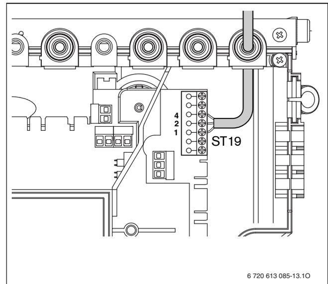
Рис 23 Подключение 24 В регулятора
