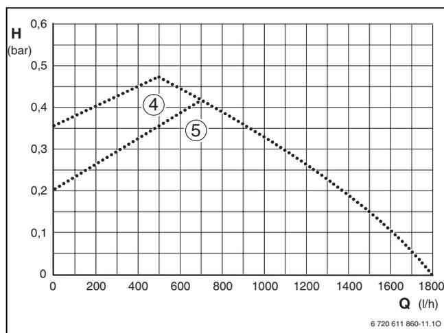
Рис 48 Пропорциональное давление
